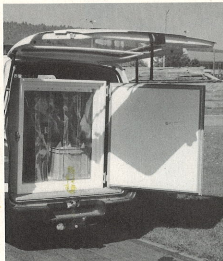
Kühl-Container für Kleinfahrzeuge, 910 Liter Inhalt Euro-Palette-Abmessung
